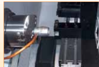
Действие 4: улавливатель деталей забирает готовые детали
