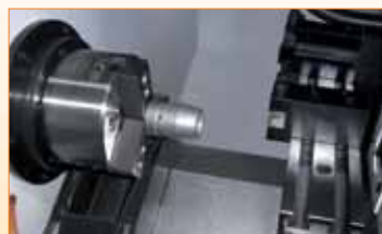
Действие 3: Патрон зажимает материал для обработки
