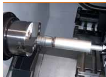
Действие 2: подача материала в шпиндель
