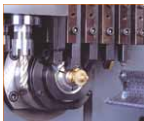
Шесть инструментов для внешней обработки
